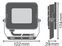
**Scheda tecnica Ledvance Proiettore LED Compatto Bianca 20W 1800lm 100D - 830 Luce Calda | IP65 - Simmetrico**
