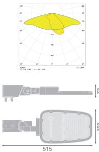
Scheda tecnica Ledvance Proiettore LED Area Medio Grigio 65W 8450lm 160x58D - 730 Luce Calda | IP66 - Simmetrico
