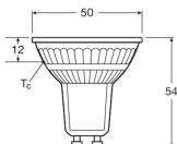
**Scheda tecnica Osram Faretti LED GU10 PAR16 2W 360lm 36D - 827 Bianco Molto Caldo | Sostitutiva 50W - Ultra Efficiency**
