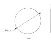
**Scheda tecnica Noxion Bulkhead LED Corido Bianca 22W 1839lm - 830 Luce Calda | 410mm - IP44**
